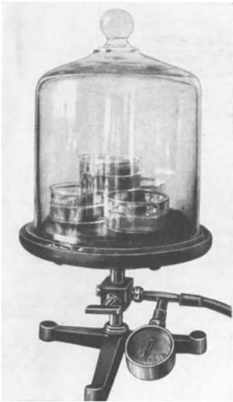
Abb. 3. Pumpenteller mit Glasglocke; unter der Glocke stehen 4 Schalen mit untergetauchten Holzklötzchen.
