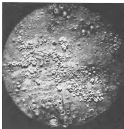
Abb. 8. Wasserdurchlässigkeitsprobe von Anstrichen auf Eisenblech durch Betupfen mit Kupfersulfat. Aufnahme Forschungsinstitut für Farbtechnik.
