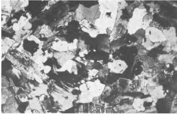
Abb. 22. Feinkörniger, gleichmäßig richtungsloser Granittyp. Druckfestigkeit: 2600 kg/cm 2 ; Schlagbiegefestigkeit: 12 Schläge bis zur Zerstörung.
