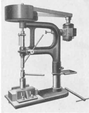
Abb. 4. Elektrische Tischbohrmaschine für Herstellung von Prüfcylindern und Hohlkörpern.
