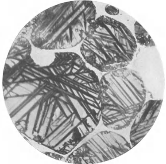
Abb. 13. Belit mit Zwillingstreifung; im auffallenden Licht (1000fach). (Nach TAVASCI.)
