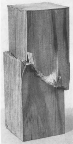
Abb. 9. Astfreie Druckprobe aus Fichtenholz nach der Prüfung.
