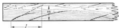
Abb. 3. Ermittlung der Faserabweichung an Schwindrissen bei Vorhandensein von Drehwuchs nach DIN DVM 2181.
