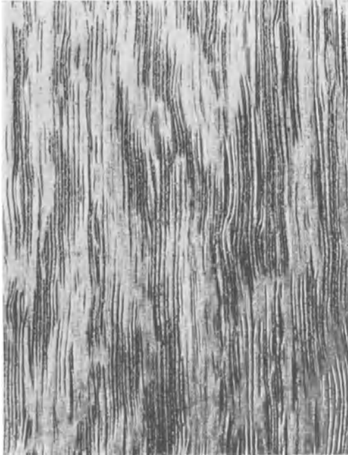
Abb. 2. Eiche, Tangentialschnitt, schwach vergrößert. Frühholzgefäße (Poren) als Nadelrisse, breite Markstrahlen als dunkle spindelförmige Streifen.
