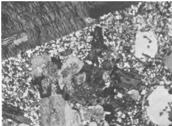
Abb. 23. Unregelmäßige Mineralausbildung im Granit; grobe Ausscheidungen wechseln mit feinen Partien; Druckfestigkeit: 1600 kg/cm 2 . Schlagfestigkeit: 8 Schläge bis zur Zerstörung.
