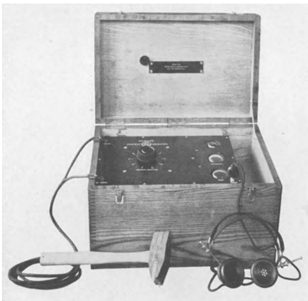
Abb. 7. Elektrisches Holzfeuchtigkeitsmeßgerät der General Electric Co., Schenectady/USA.
