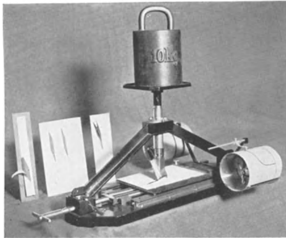
Abb. 7. Haftfähigkeits(Abschiebe)apparat nach ROSSMANN (I.G.). Aufnahme Dr. ROSSMANN.
