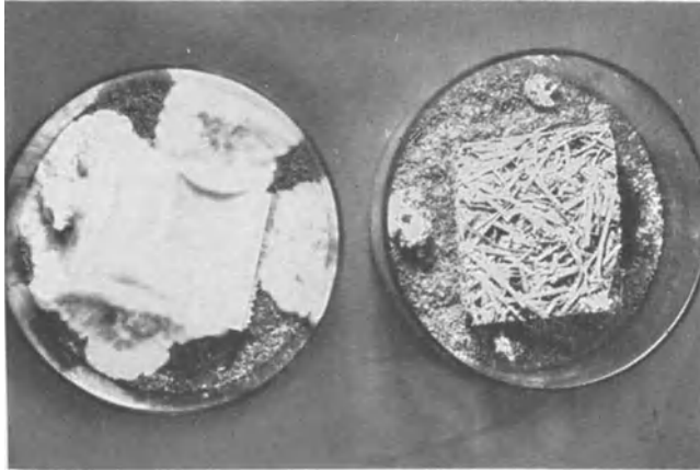
Abb. 12. Zustand von Fichtenholz (links: allseitig überwuchert) und einer magnesitgebundenen Holzwolleplatte (rechts ohne jeden Mycelzuwachs) nach Impfung mit Hausschwam-Mycel und dreiwöchiger Kultur (Aufnahme R. GISTL).
