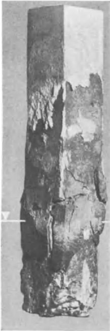
Abb. 6. Zerstörung durch Natriumsulfatlösung.
