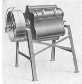
Abb. 35. Gewellte Trommel für den Abriebeversuch an würfelförmigen Prüfkörpern.
