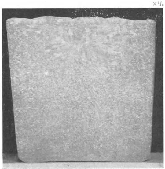
Abb. 5. Kupferbarren mit feinkörnigem Gefüge.
