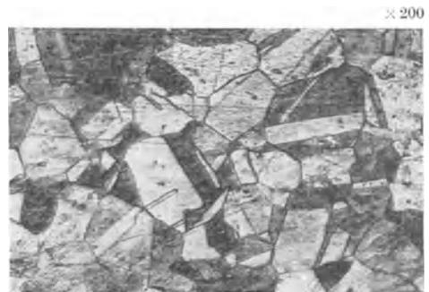
Abb. 2. Kupfer-Rekristallisationsgefüge.
