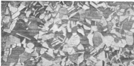
Abb. 30. Feinkörniges  $\alpha$ -Messing mit glatter Tiefungsprobe.
