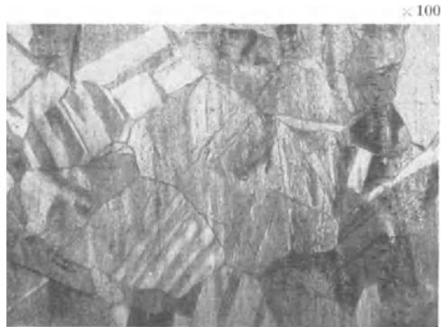
Abb. 21. Rekrystallisationsgefüge von Ms 85.
