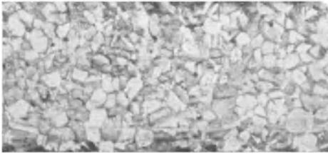
Abb. 32.  $\alpha$ -Gefüge mit dunklen  $\beta$ -Einschlüssen.
