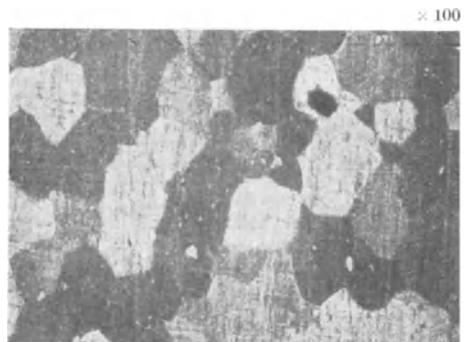
Abb. 23. Reines  $\beta$ -Gefüge im Ms 58 (abgeschreckt).
