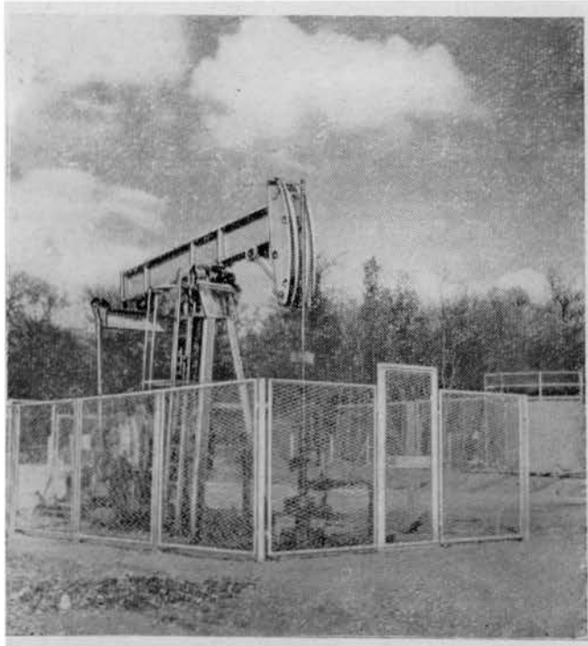
Рис. V.5. Оборудование глубокой глубиннонасосной скважины на площади Глубокий Ляк.
