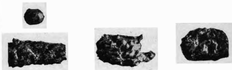
Рис. 136. Внешний вид образцов чугуна, взятого из горна доменной печи № 1 Магнитогорского завода на горизонте фурм в различных точках по радиусу. Натур. вел.
