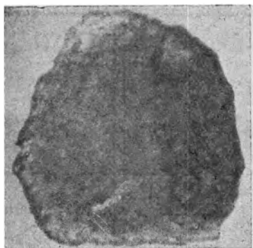
Рис. 71. Внешний вид образца № 342 чугуна, извлеченного из распара
