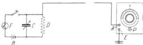
Abb. 11. Schaltungsschema zur Justierung des Neutrodyneempfängers.
