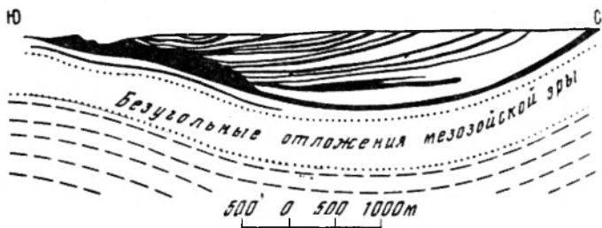
Коркинское месторождение угля. Челябинский угленосный бассейн. Расчленение мощного пласта угля (по А. Д. Рубану)
