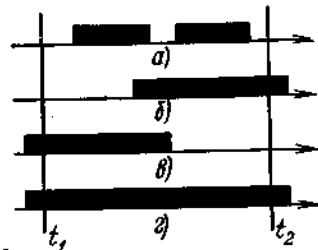
Рис. 3.1. Диаграмма различных случаев занятия выходов коммутационной системы за промежуток времени [t_1, t_2)
