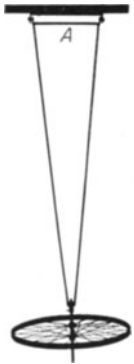
Abb. 168. Ein um die Achse A pendelnd aufgehängter Kreisel. Zwei Freiheitsgrade.
