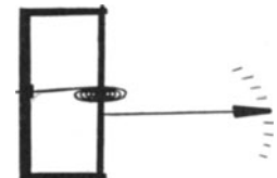
Abb. 119. Schema eines elektrischen Meßinstrumentes mit linearer Skala.
