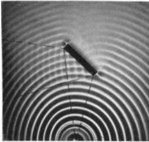
Abb. 380. Reflexion von Kreiswellen an einem Spiegel.
