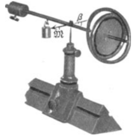
Abb. 157. Kippung eines ruhenden Kreisels unter der Einwirkung eines Drehmomentes.
