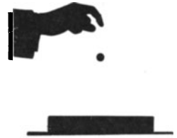
Abb. 108. Zum Energiesatz. Eine Stahlkugel tanzt über einer Stahlplatte.
