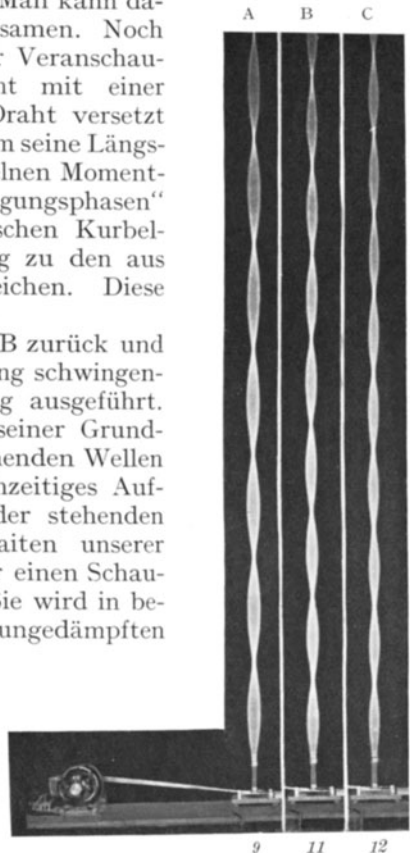
Abb. 321. Stehende Querwellen eines Gummischlauches, mit Talkum geweißt vor schwarzem Vorhang. Links ein Elektromotor mit Exzenter. Das obere Drittel des Bildes ist abgeschnitten.
