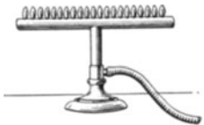
Abb. 397. Der zur Herstellung einer vertikalen Heißluftschicht in Abb. 398 gebrauchte Gasbrenner.
