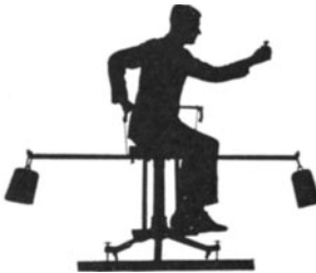
Abb. 182. Ein Drehstuhl mit hohem Trägheitsmoment zur Vorführung von Corioliskräften. Die hier gezeichneten Zusatzmassen benutzt man zweckmäßig auch bei den in den Abb. 174, 176, 178, 180 dargestellten Versuchen.
