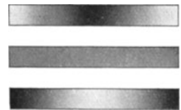
Abb. 344. Zur Veranschaulichung einer stehenden Längsschwingung in einer Luftsäule (1. Oberschwingung).
