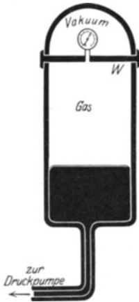
Abb. 224. Zusammenhang von Druck und Volumen eines Gases.
