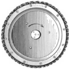
Abb. 66. Kette auf Schwungrad. Zur Vorführung einer dynamischen Stabilität.
