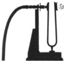
Abb. 297. Hydrodynamische Selbststeuerung einer Stimmgabel.
