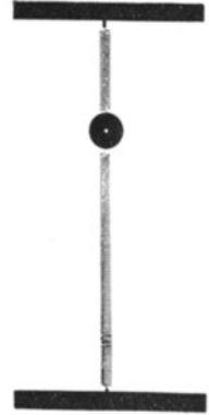
Abb. 92. Herstellung von Lissajous-Schwingungen mit Hilfe elastischer Kräfte.
