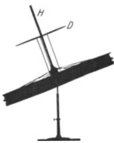
Abb. 154. Kräftefreier Kreisel mit raumfester Figurenachse.
