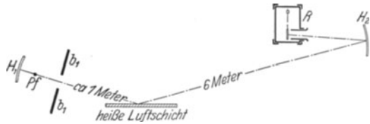
Abb. 398. Spiegelung eines Schallstrahles an einer heißen Luftschicht.
