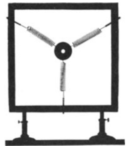
Abb. 88. Zur Herstellung elliptischer Schwingungen.
