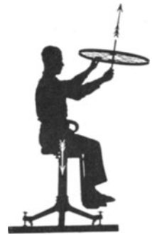
Abb. 139. Zur Erhaltung des Drehimpulses.
