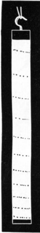
Abb. 32. Fallkörper mit Zeitmarken und deren Auswertung mit den üblichen Versuchs- und Ablesungsfehlern. Dieser Versuch soll vor allem zeigen, daß die Messung eines zweiten Differentialquotienten stets eine mißliche Sache ist.
