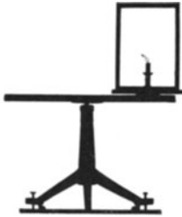
Abb. 239. Eine Flamme unter dem Einfluß von Trägheitskräften.
