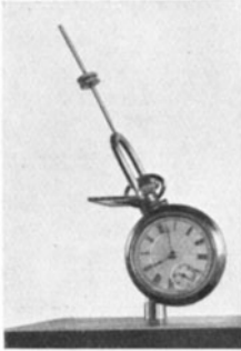
Abb. 356. Resonanz zwischen Uhrgehäuse und Unruhe.
