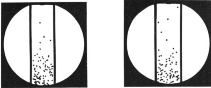
Abb. 234. Zwei Momentbilder eines Stahlkugelmodellgases zur Veranschaulichung der Barometerformel. Expositionszeit je 8 \cdot 10^{-4} Sekunden.
