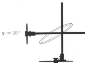
Abb. 82. Zusammensetzung zweier zueinander senkrechter linear polarisierter Schwingungen bei ungleichen Amplituden und einer Phasendifferenz von rund 30^\circ .
