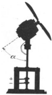
Abb. 141. Ein um die Vertikale drehbarer Zimmerventilator zur Vorführung des Impulserhaltungssatzes.
