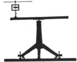
Abb. 183. Ein Drehpendel auf einem Karussell. Das Drehpendel besteht aus einem Holzstab auf der aus Abb. 126 bekannten kleinen Drillachse.
