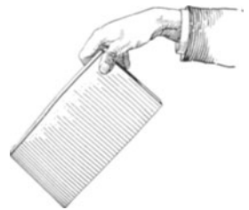
Abb. 148. Abschleudern einer Kiste zur Rotation um ihre freie Achse. A mit größtem Trägheitsmoment.
