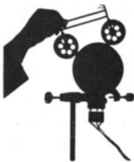
Abb. 160. Ein Fahrradmodell wird durch Anpressen an eine Scheibe auf der Achse eines Elektromotors in Gang gesetzt.
