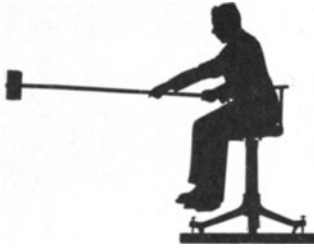
Abb. 140. Mit Hilfe eines langen Holzhammers lassen sich Drehimpulse mit verschiedenen Achsenrichtungen erzeugen.
