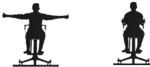
Abb. 23. Gestaltsänderungen bewirken Änderung der Drehgeschwindigkeit.
