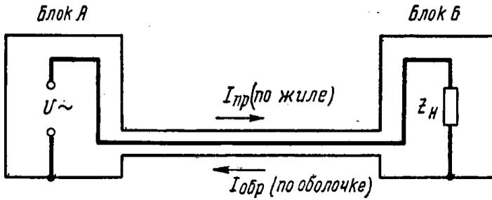
Рис. 2-20. Полное экранирование электрического и магнитного полей.
