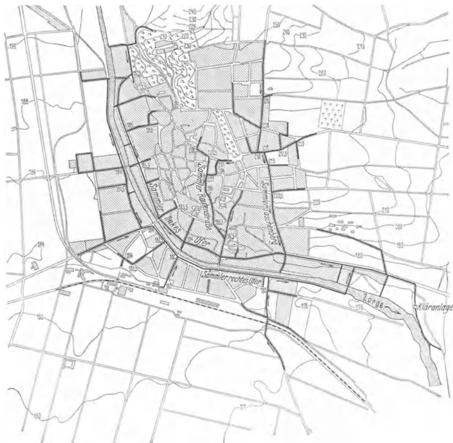
Abb. 94. Entwässerungssystem von Nordhausen.
