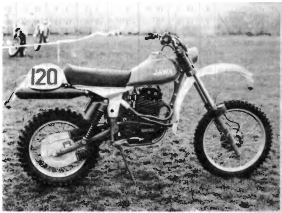
Рис. 104. На мотоцикле «Ява» класса выше 500 см 3 установлены четырехтактные двигатели «Ротакс»
