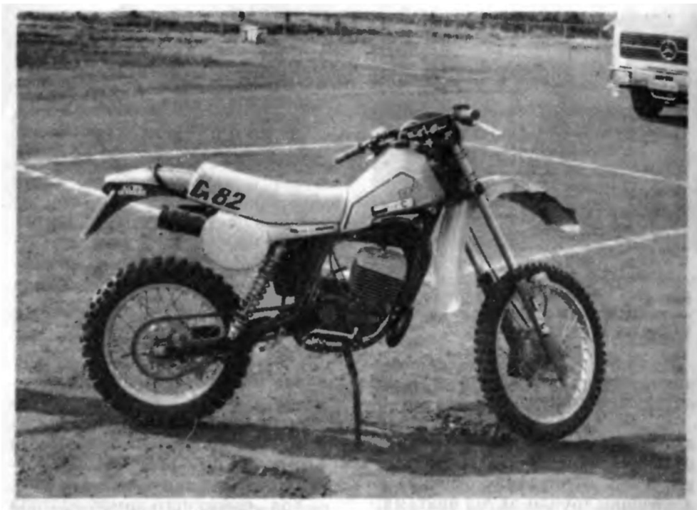
Рис. 220. Мотоцикл эндуро, участвовавший в шестидневных соревнованиях 1982 г., когда действовало правило ограничения хода обоих колес до 250 мм (фактический ход можно оценить по зазору между колесами и грязевыми щитками)
