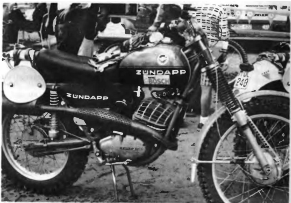
Рис. 81. Мотоцикл «Цюндапп» отличается хорошим охлаждением головки цилиндра двигателя
