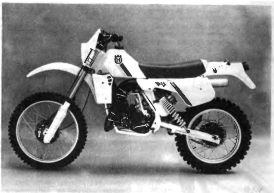
Рис. 211. Удачная конструкция мотоцикла эндуро предполагает сбалансированность двигателя, привода и ходовой части (мотоцикл «Хускварна» с двигателем водяного охлаждения)
