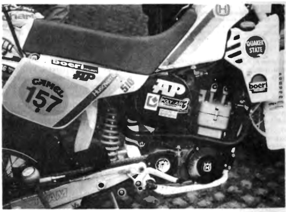
Рис. 115. Новинка среди мотоциклов «Хускварна» — мотоцикл класса свыше 500 см 3 с четырехтактным двигателем, имеющим водяное охлаждение
