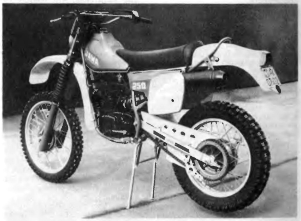
Рис. 121. «Ява 250», участница сезона 1985 г., с центральным амортизатором и маятниковой вилкой, подвешенной на игольчатом роликоподшипнике
