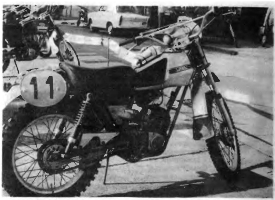
Рис. 93. Двигатель мотоцикла «Ява-Татран», изготовленный на заводе в Поважске-Бистрице, имел газораспределение вращающимся золотником
