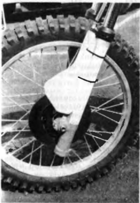
Рис. 228. Дисковые тормоза используются и на мотоциклах эндуро
