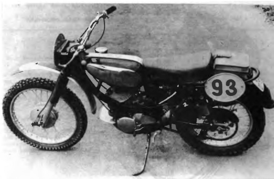
Рис. 66. На первых моделях спортивных мотоциклов «Ява 250» с рамой в форме банана, переднее колесо было закреплено на вилке с выносом вперед, серийный топливный бак был развернут на 180°
