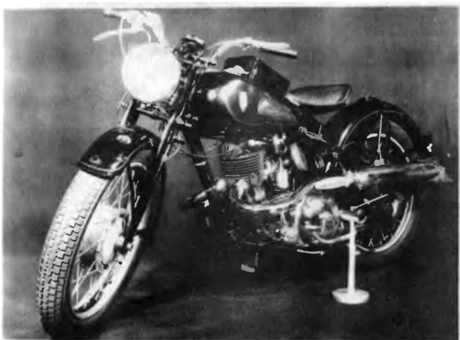
Рис. 29. Двигатель мотоцикла ДКВ был оборудован системой наддува
