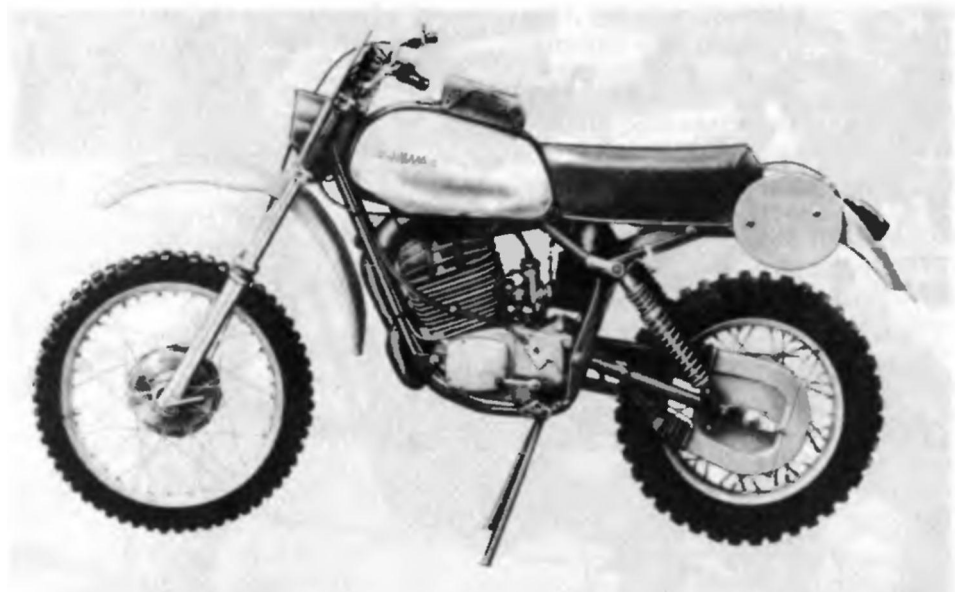
Рис. 94. Мотоцикл «Ява 551» с одноцилиндровым двигателем. Одноцилиндровый двигатель с рабочим объемом свыше 500 см 3 — это целая история народного предприятия «Ява»
