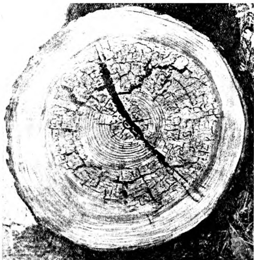
Рис. 57. Древесина сосны, поврежденная Polyporus Schweinitzii . (Оригин.)
