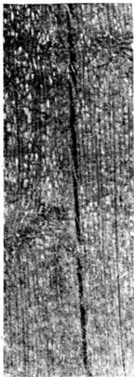
Рис. 21. Древесина сосны, поврежденная Trametes pini . (Из Тюбефа).
