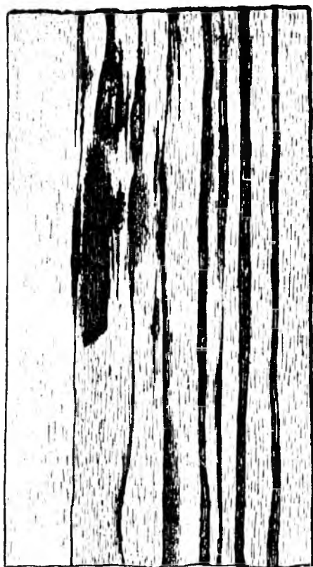
Рис. 77. Древесина березы, поврежденная Daldinia concentrica (Ориг.)
