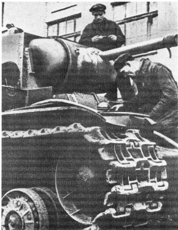
Устранение повреждений на танке КВ, вернувшемся из боя.
