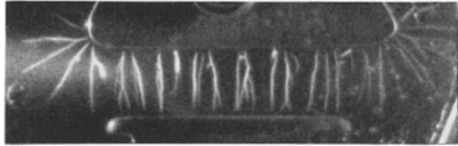
Abb. 15. Positive Entladung von einem Draht gegen eine Platte (7,6 KV, Luft). [Nach RAETHER (20).]
