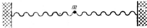
Рис. 12.3. Масса m , прикрепленная к двум пружинкам и могущая двигаться вдоль их направления. Частота колебаний зависит только от величины массы и упругих свойств пружинки.
