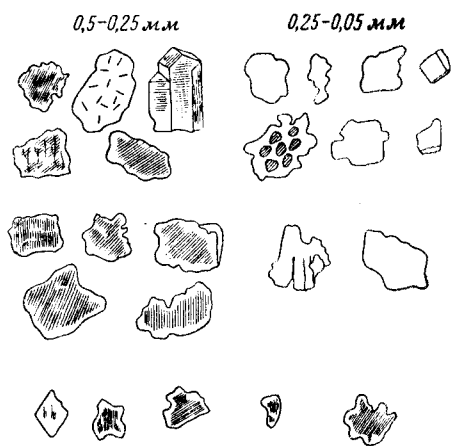
Рис. 21. Характер зерен доломитовой муки из фракции 0,5—0,25 и 0,25—0,05 мм. По З. А. Богдановой (1940)
