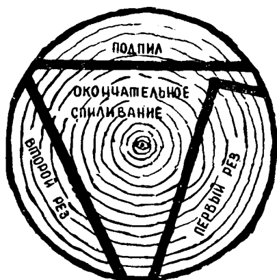
Рис. 45. Спиливание толстомерного дерева по способу А. Косарева
