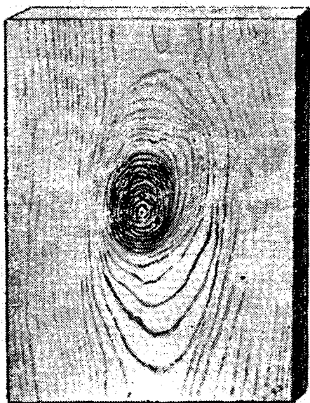
Рис. 8. Сучок здоровый, твердый, сросшийся.
