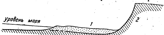
Рис. 47. Залегание песков древнечерноморской террасы у с. Рыбачьего на Южном берегу Крыма. Террасовые отложения (1) прилонены к абразионному уступу (2), сложенному коренными породами
