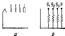
Рис. 15.1. а — пентод; б — эквивалентная узловая сеть.
