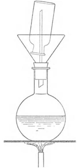
Fig. 12. Vorrichtung zum Ausdämpfen der Arzneigläser.
