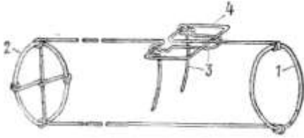
48. Норная ловушка (по В. Лавровский, 1976). 1 — наружное кольцо; 2 — внутреннее кольцо; 3 — дверца; 4 — основание дверцы.
