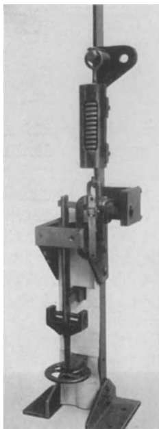
Abb. 133. Einfache Prüfvorrichtung, Messung mit geeichter Schraubenfeder.
