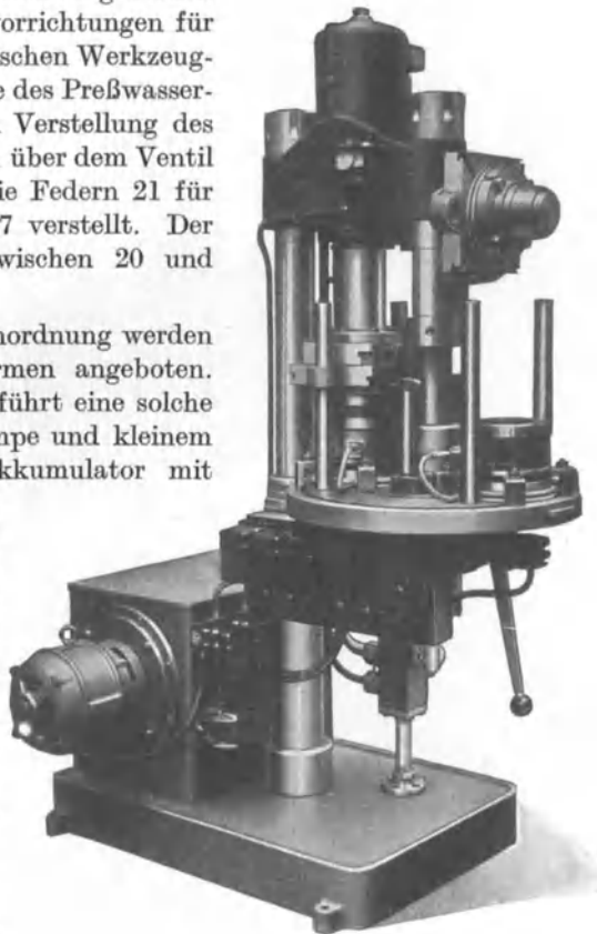
Abb. 25. Drehtischpresse für 2 Preßformen, eine Form unter Druck, die andere aufgeklappt. Hahn & Kolb, Stuttgart.
