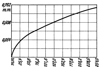
Abb. 62. Schrumpfung von Hartgummimischungen nach H. Warren, Electrical Insulating Materials.
