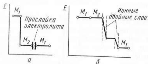
Рис. 62. Локализация разности потенциалов в правильно разомкнутой электрохимической цепи M_1 | M_2 | \text{электролит} | M_1 : а — по теории Вольта; б — по теории Нернста
