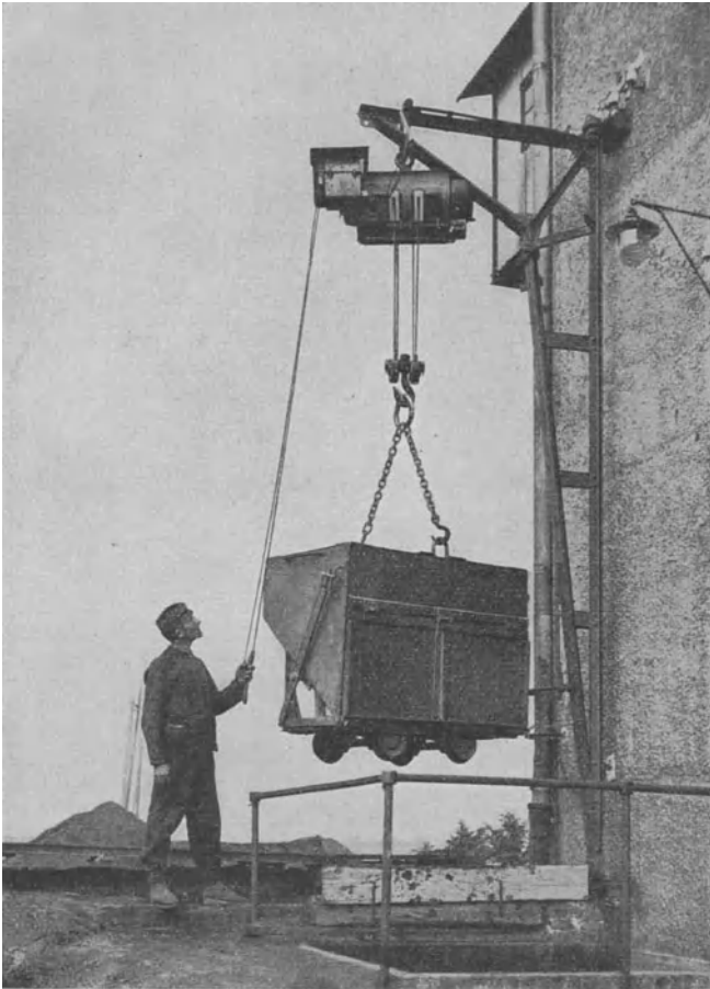
Fig. 140. Wandschwenkkran zum Hochziehen der Aschewagen.
