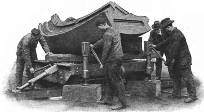
Fig. 51. Anheben eines schwer beladenen entgleisten Schienenwagens durch Daumenkräfte.
