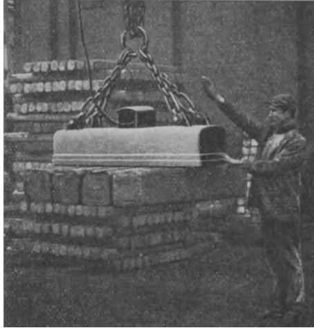
Fig. 66. Flachmagnet beim Verladen von Stahlblöcken.
