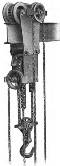
Fig. 82. Obergurt-Laufkatze mit eingeb. Schneckenhebezeug.
