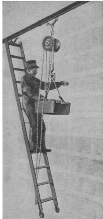
Fig. 172. Hängebahn mit fahrbarer Leiter vor einem Lagergestell.
