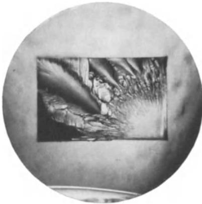
Abb. 50. Von der Kristalloberfläche ausgehende „Spiegel“-bildung auf der Würfelreißfläche eines synthetischen Steinsalzkristalls mit hohem Fremdstoffgehalt (7fache Vergrößerung). (H. SCHÖNFELD.)
