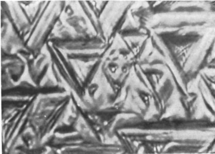
Abb. 11. (111)-Spaltebene eines Bi-Kristalls, geätzt mit verdünnter Salpetersäure (mehrhundertfache Vergrößerung). Tetraederförmige Ätzgruben. (A. Goetz.)
