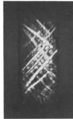
Abb. 43. Doppelbrechende Gleitschichten in einem synthetischen KCl-Kristall. Reißstück eines Würfelspaltstäbchens (6fache Vergrößerung). Rhombendekaderebenen- und nichtkristallographische Gleitschichten. (W. SCHÜTZE.)
