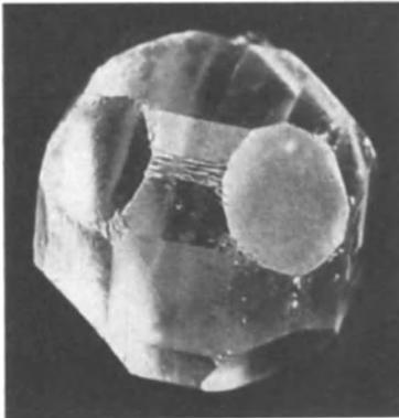
Abb. 3. Makroskopisch vergrößerte Rippung der Rhombendodekaederebene (110) eines Kugelwachstumskörpers von Steinsalz bei raschem Wachstum (A. NEUHAUS).
