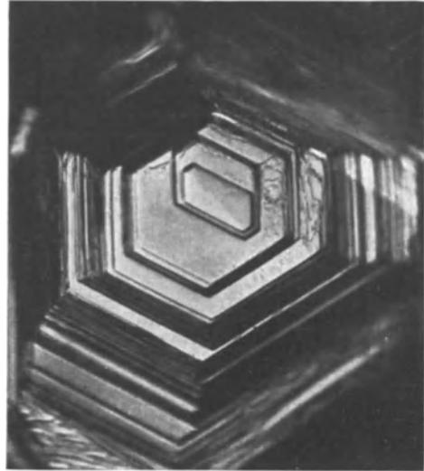
Abb. 5. Durch Sublimation bei 310° C wachsender Cadmiumkristall (100fache Vergrößerung). Schichtpyramidenform, Keimwachstum auf den hexagonalen Basisebenen (M. STRAUMANIS).
