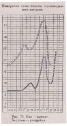
диаграмм, где по осям абсцисс отложена высота тона, а по осям ординат — сила звука, выраженная в секундах звучания камертона (рис. 72-74). Параллельно здесь же приведены кривые нарастания силы звука в спетых разными певцами гаммах, полученные проф. Зерновым абсолютной путем намерения силы звука "фонометром", сконструированным ИΜ прибором вполне совпадающие с полученными мною данными (рис. 75-81).
