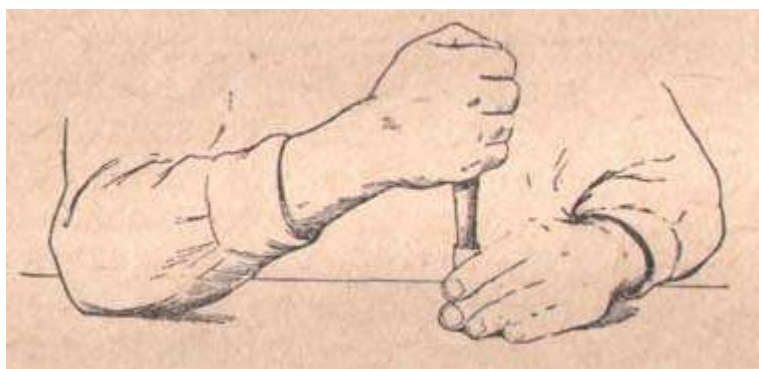
Рис. 56. Прием досылаания картонной прокладки до пороха жестким (непружинным) навойником, обеспечивающий практически однородную плотность заряжения
