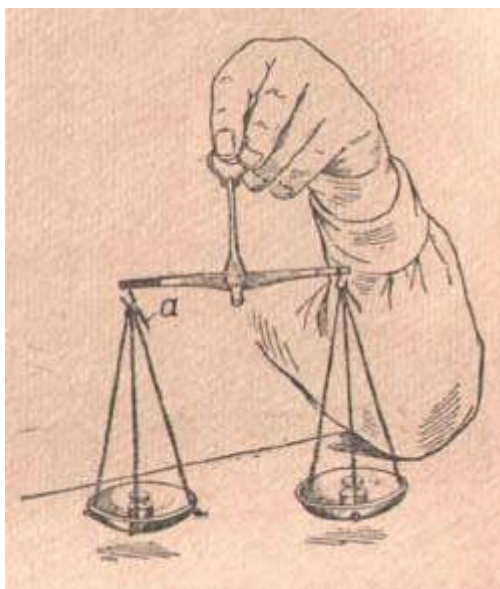
Рис. 48. Прием выверки аптекарских весов: а-ниточка, путем укорочения которой достигают равновесия чашечек
