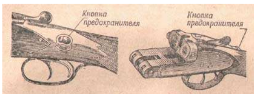
Рис.35. Различное расположение кнопки предохранителя
