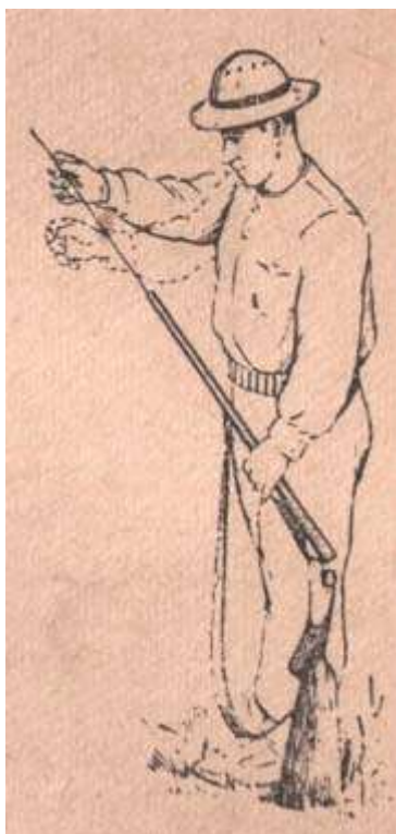
Рис. 82. Наиболее безопасный прием извлечения застрявшего в патроннике ружья патрона при помощи шомпола. Пунктиром показано положение руки после броска шомпола
