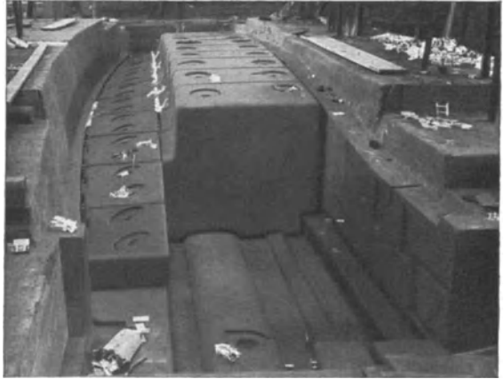
Abb. 23. Zusammenbau einer großen Form.
