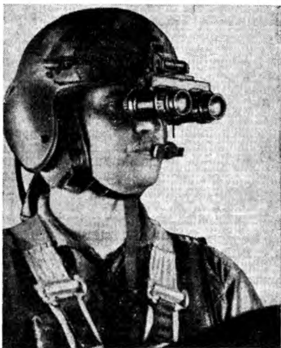
Рис. 42. Очки ночного видения AN/PVS-7 для вождения машин и стрельбы из оружия с лазерной подсветкой
