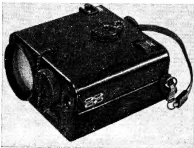
Рис. 36. Наблюдательный прибор M931 с лазерным дальномером на GaAs
