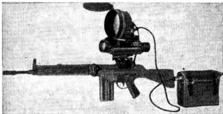
Рис. 25. Активный прицел В8V с ИК-прожектором и блоком питания
