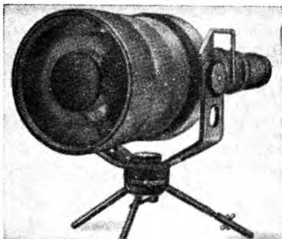
Рис. 31. Прибор ночного видения «Стар-Троп» с трехкамерным ЭОП I поколения
