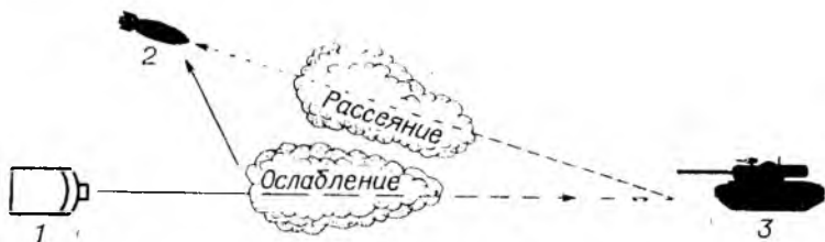
Рис. 87. Действие задымления на лазерную систему наведения ПТУР: 1 — лазер; 2 — ракета; 3 — танк
