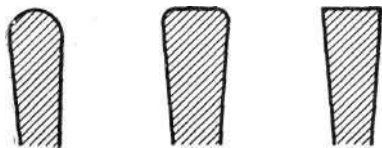
Рис. 51. Основные формы поперечного сечения обуха клинка.
