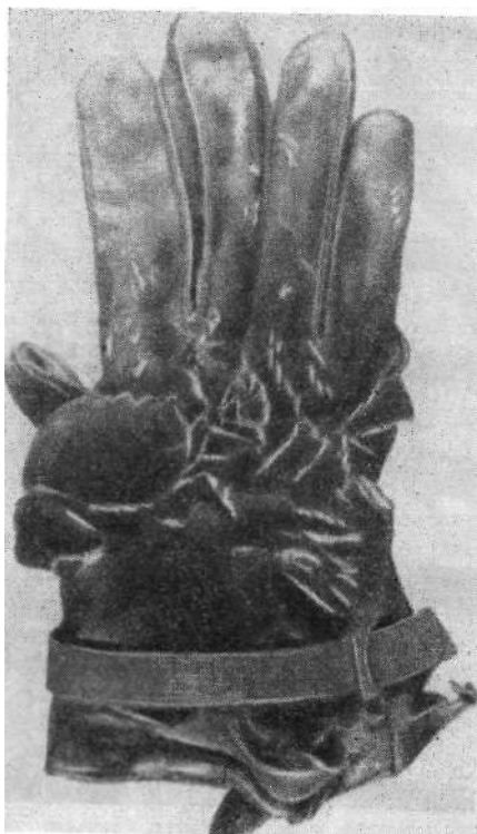
Рис. 91. Надрывы тыльной поверхности компенсирующей перчатки от перерастяжения при ударе. В момент удара рука летчика в перчатке охватывала рукоятку (наблюдение И. М. Алпатова).
