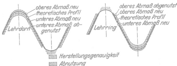
Abb. M 22 und 23. Lage der Herstellungsgenauigkeit und Abnutzung der Gutlehren für das Whitworth-Gewinde.
