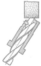
Abb. B 11. Büchsenhalter für Spiralbohrerschleifmaschinen aus Werkstattbuch 16, Dinnebier, bis 10 mm Durchmesser.
