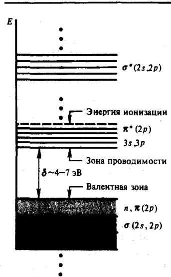
Рис. XIII.10. Энергетическая схема полипептидной цепи (объяснение см. в тексте) (по Е. G. Petrov, 1978)
