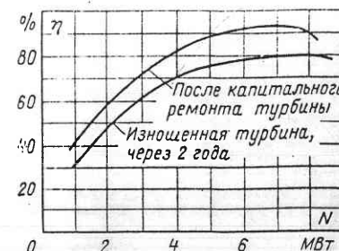
Рис. 10.10. Влияние износа на характеристику радиально-осевой турбины
