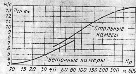
Рис. 6.13. Зависимость средней скорости во входном сечении спирали от напора
