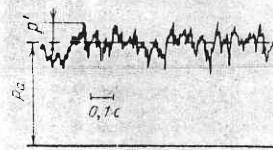
Рис. 7.3. Пульсация давления в турбулентном потоке
