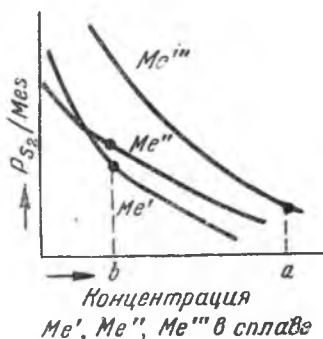
Рис. 89. Кривые упругости диссоциации сульфидов трех металлов, растворенных в металлической ванне
