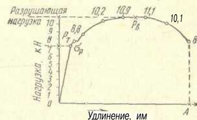
Рис. 1.6. Диаграмма растяжения стали
