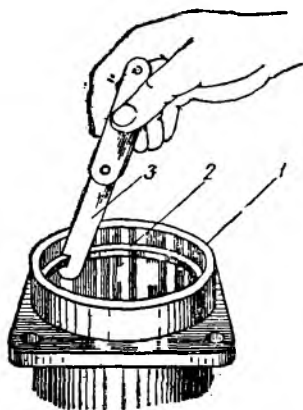
Фиг. 108. Замер зазора в замках поршневых колец: 1 — цилиндр; 2 — поршневое кольцо; 3 — щуп.
