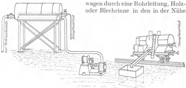
Abb. 24. Einrichtung zur Entleerung von Kesselwagen.
