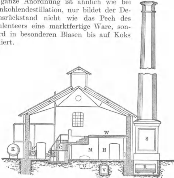
Abb. 29. Braunkohlenteer-Destillationsanlage (Aufriß) (aus Scheithauer, Schwelteere).
