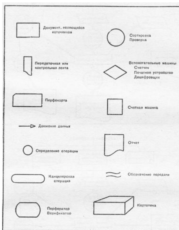
Рис. 30. Стандартные условные обозначения для схем последовательности выполнения операции
