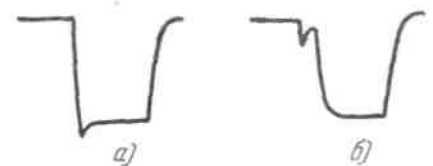
Рис. V. 3. Фронты напряжений триггера: а) при нормальной величине запускающих импульсов, б) при слишком больших запускающих импульсах.
