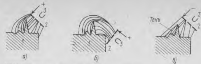
рис. 4.23. Схема движения электронов к коллектору: а — вторичных и отраженных электронов; б — вторичных электронов; в — отраженных электронов; 1 — образец; 2 — сетка; 3 — сцинтиллятор
