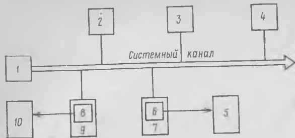
Рис. 4.28. Упрощенная структурная схема автоматизированного оже-спектрометра:
