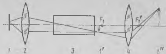
Рис. 4.1. Оптическая схема лазерного проекционного микроскопа:
