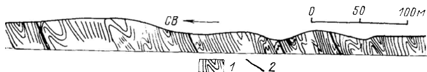
Рис. 5.46. Характер складчатости в большекаройской свите по руч. Шабакты. Хр. Каратау (по Е. И. Паталахе и Т. В. Гиоргобани [1975 г.]). 1 — очертания складок; 2 — кливажные разрывы.
