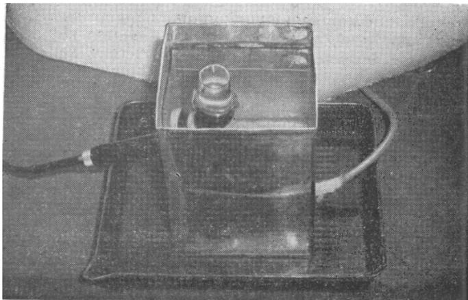
Рис. 5. Металлический резервуар — резонанс с вмонтированной ультразвуковой головкой УТП-1.
