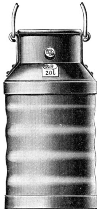
Fig. 12. Kannenförmiges Flüssigkeitsmaß, getrieben; mit schwach gewölbter Bodenfläche. Begrenzung durch gestempelte Stifte. Bezeichnung auf besonderem Schild, durch Stempel und Jahreszeichen gesichert.
