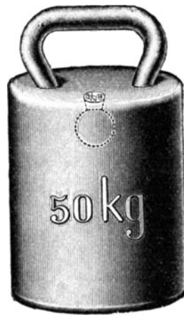
Fig. 26. Gewicht mit Justierhöhlung aus Gußeisen.
