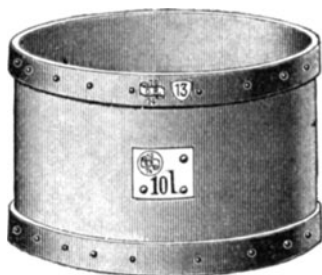
Fig. 18. Hohlmaß aus Metall. Durch Stempelung gesichertes Schild.
