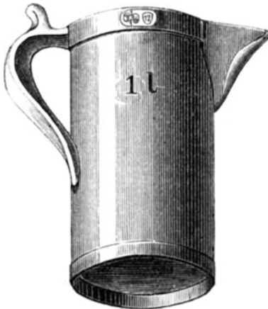
Fig. 9. Flüssigkeitsmaß aus Zinn mit Ausguß, Stempel und Jahreszeichen über der Bezeichnung.
