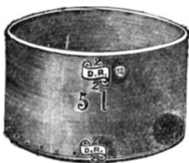
Fig. 16. Spanmaß ohne Beschlag. Stempelung über der Bezeichnung und am Boden.
