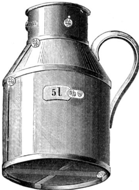
Fig. 11. Kannenförmiges Flüssigkeitsmaß, gelötet. Bezeichnung auf besonderem Schild, durch Stempel und Jahreszeichen gesichert. Stempel unter den Begrenzungsmarken und auf den Lötnähten.
