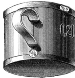
Fig. 10. Weichgelötetes Flüssigkeitsmaß. Stempel und Jahreszeichen über der Bezeichnung am oberen Rande und Stempel auf der Lötnaht.
