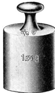
Fig. 28. Gewicht ohne Justierhöhlung aus Messing in hoher Zylinderform mit Knopf.
