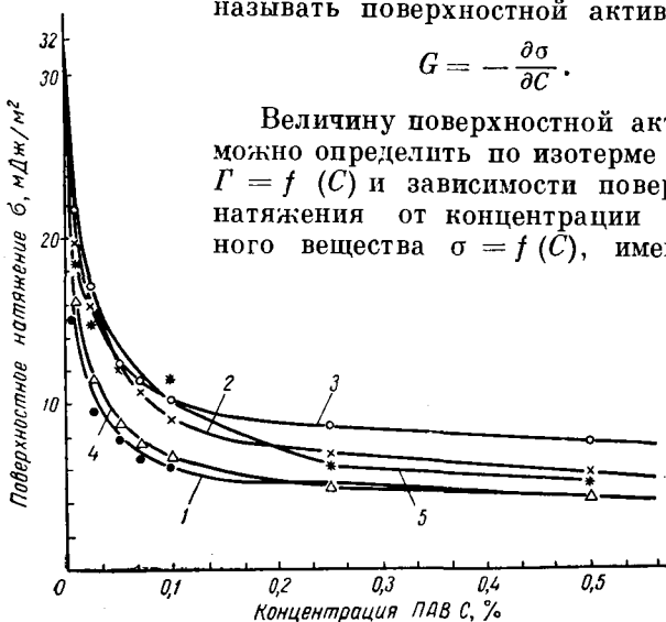
Рис. VIII.1. Изотермы поверхностного натяжения водных растворов неионогенных ПАВ на границе с нефтью.
