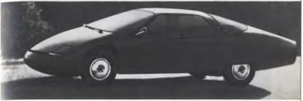
Перспективная модель 90-х годов «Ситэйшн — IV» компании «Дженерал моторс», ожидаемый расход топлива 3,9 л на 100 км, коэффициент аэродинамического сопротивления 0,18.
