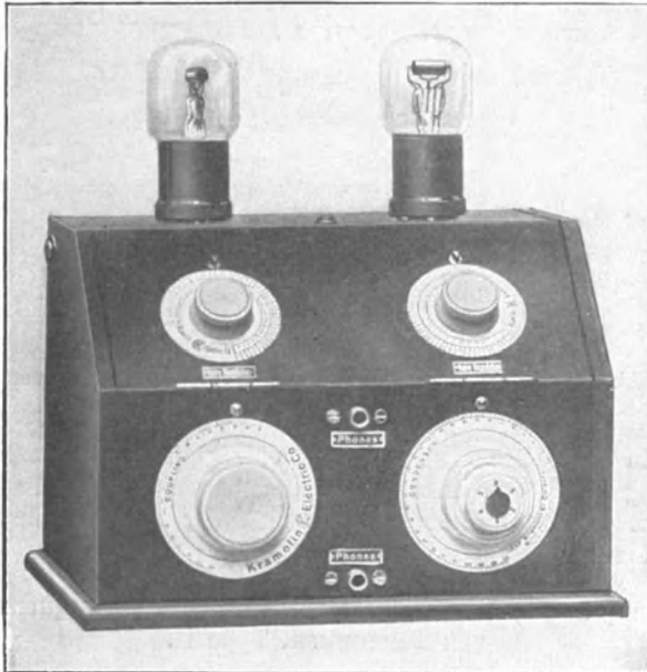
Abb. 80. Hochfrequenzverstärker-Audionempfänger von Kramolin im gebrauchsfertigen Zustand.
