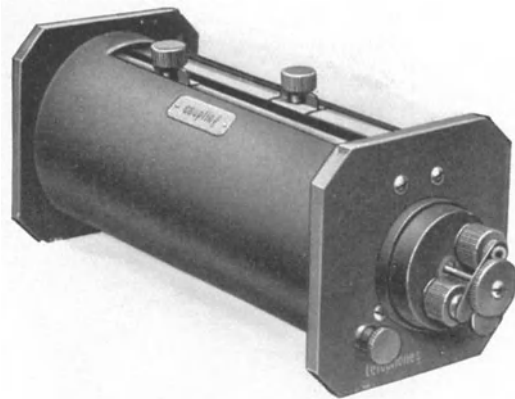
Abb. 70. Einfacher Schiebepulvenempfänger mit Kristalldetektor von G. Seibt.
