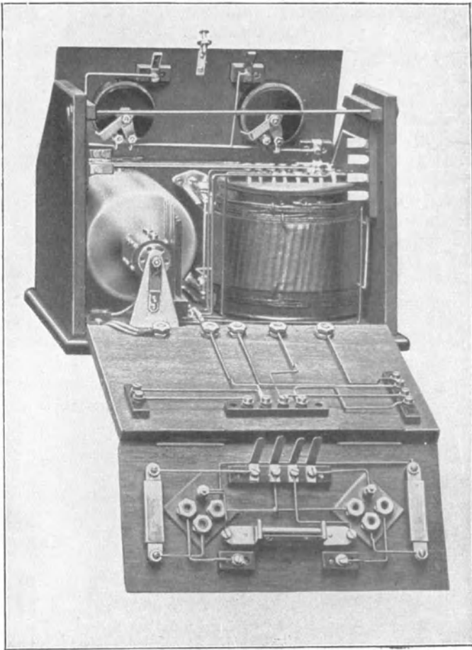
Abb. 81. Hochfrequenzverstärker-Audionempfänger von Kramolin in auseinandergeklapptem Zustand.
