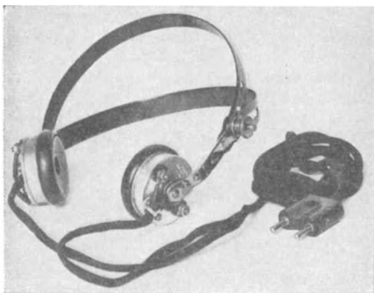
Abb. 284. Telephon mit ausgesprochener Resonanzlage für Radiotelegraphie von H. W. Sullivan.
