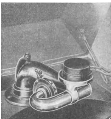
Abb. 162. Benutzung des Grammophon-schalltrichters als Lautsprecher.
