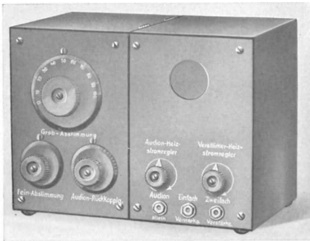
Abb. 83. Audionempfänger kombiniert mit Zweifach-Niederfrequenzverstärker von Telefunken, Type Telefunken „D“.
