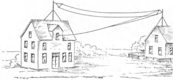
Abb. 131. Ungünstige Anordnung einer L-Antenne.
