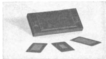
Abb. 176. Glimmerkondensator für Empfangszwecke von G. Seibt. Vor dem Kondensator liegen einzelne Glimmerblätter mit Belegen.
