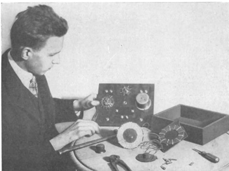
Abb. 337. 3. Stadium: An der Schaltplatte sind von der Rückseite aus die Kontaktbahnen und der Drehkondensator sowie die schon im Stadium 2 erwähnten Kontakt- und Schaltelemente angebracht.
