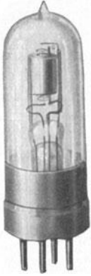
Abb. 246. Edisvan-Empfangsröhre Type AR der Edison Swan Electric Co., Ltd., London.
