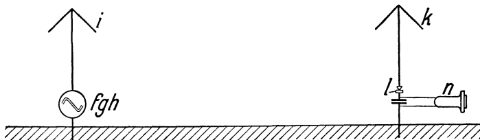
Abb. 7. Schema der drahtlosen Nachrichtenübermittlung vom Sender bis zum Empfänger.
