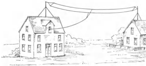
Abb. 130. Richtige Anordnung und Ableitung einer T-Antenne.
