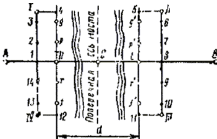
Рис. 7.10. Схема вынесения осей опор моста на обноски
