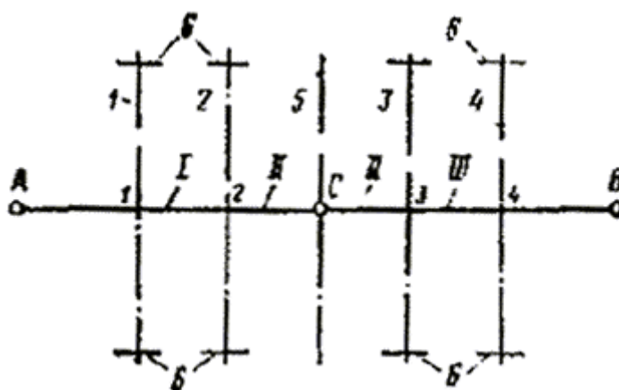
Рис. 7.12. Схема разбивки многопролетного моста:
