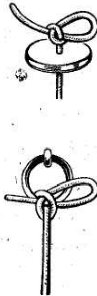
Рис. 91. Развязывающийся простой узел
