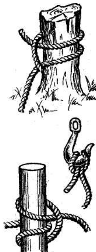
Рис. 45. Самозатягивающийся узел с полуштыком
