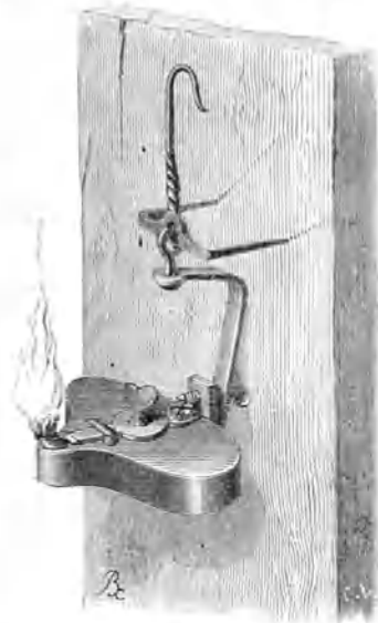
Fig. 71. Davy'sche Sicherheitslampe, im Holz gebräuchlich
