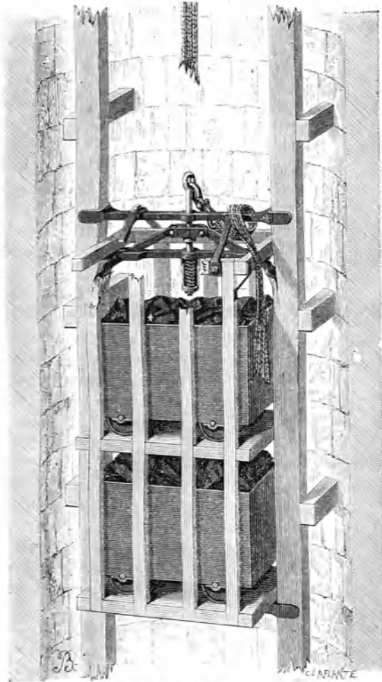
Fig. 68. Saftluft nach erfolgtem Seilbruch.
