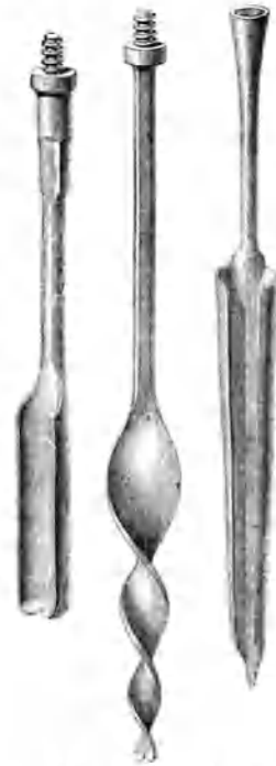
Fig. 26. Fig. 27. Fig. 28. Erdbohrer für weiche Massen
