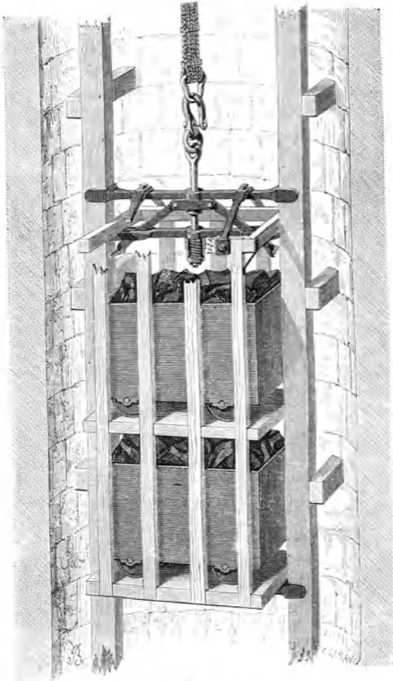
Fig. 67. Fahrstuhl mit Fangvorrichtung.
