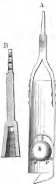
Fig. 37. A Bohrlöffel mit Augenlöcher b, c, d. B Fangglocke.
