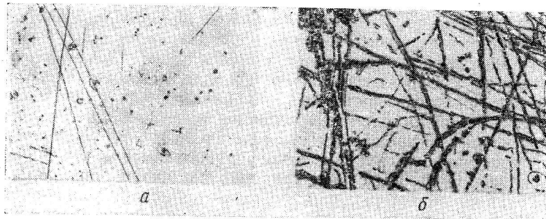
Фиг. 192. Выделение фазы в деформированном сплаве Ni—Be (по Графу).
