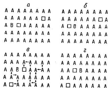
Фиг. 41. Схематическое изображение гетеродиффузии по вакантным узлам.
